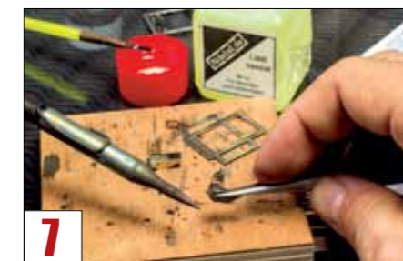
Die Teile des Schrankenbocks werden jeweils aus einem Teil gefaltet und anschließend verlötet. Lötöl leistet dabei gute Dienste.
