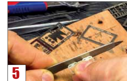
Eine kleine Diamant-Feile aus dem Kosmetikbedarf hilft dabei, die Grate der feinen Messingbauteile zu entfernen.
