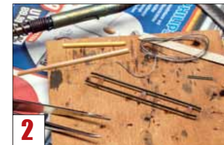
Code-40-Gleisprofile, auf Pertinax gelötet, begrenzen die für Nebenbahnen typische Füllung zwischen den Profilen.
